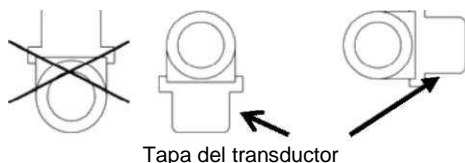
Fig. 4: Posición de instalación recomendada para la medición de la refrigeración
