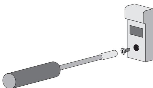
Esempio d'installazione di un ripartitore di calore mod. HYDROCLIMA-RFM con la chiave BRR7 e un dado BRR6
